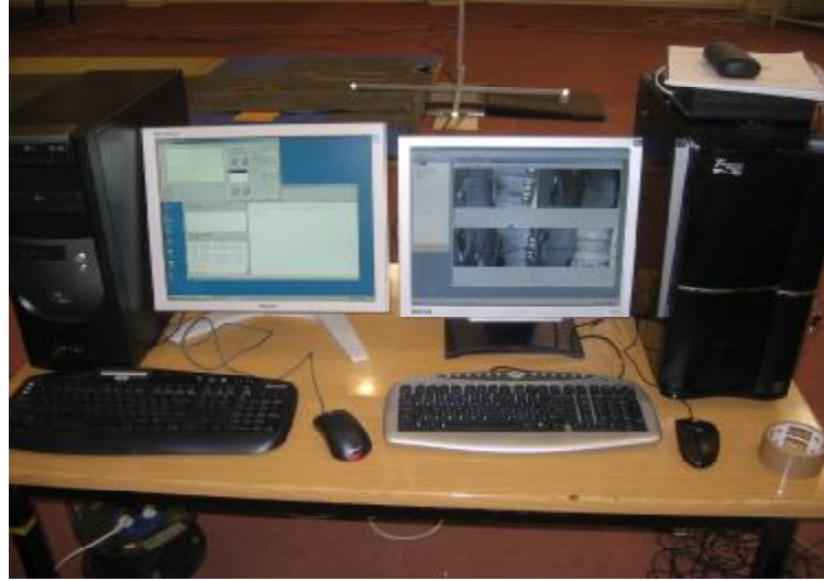
Şekil 3.1: Deney düzeneğinde kullanılan hareket analizi sistemi (SIMI 7.5) ve kuvvet platformunun (FP4060–10, BERTEC, A.B.D.) bilgisayar üniteleri.
